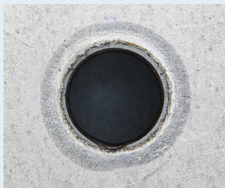
1 Prozess der Laserkantenveredlung. 2 Laserkantenveredelte Probe für Lochaufweitungstest.
